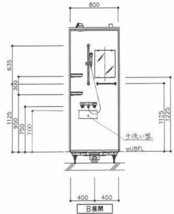
\*UB挿付高さ調整範囲 187~227mm
